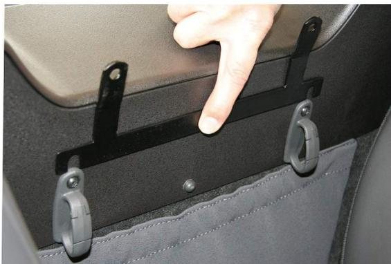
Schrauben Lösen und Halter unter Schraube
